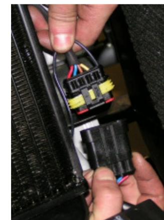
Verbinden Sie den Motorenkabelstrang mit dem Steuergerät am Batteriekasten.
