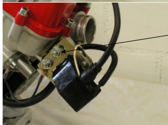
Montieren Sie die beiden Flanschmuttern und ziehen sie mit 10Nm fest.
