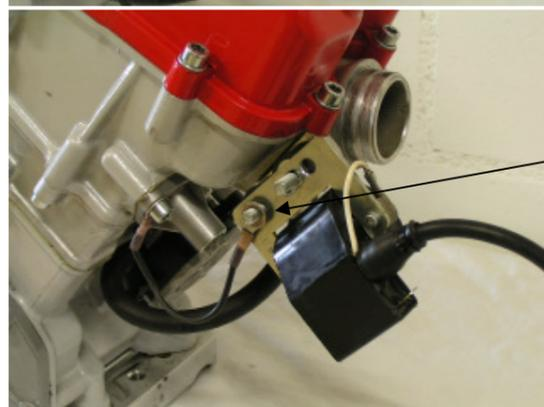
Legen Sie das Massekabel über den Bolzen des unteren Silentblocks.
