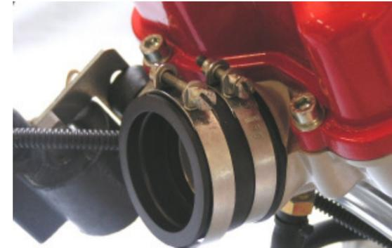
Legen Sie beide Schlauchklemmen auf den Vergasergummi und stecken diese auf den Ansaugflansch.
