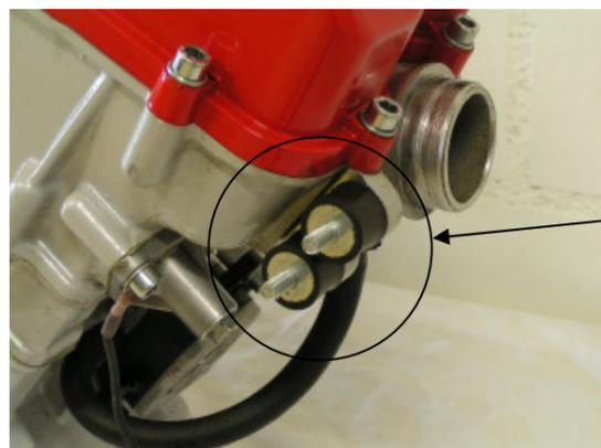
Legen Sie die Zündspule in die beiden Silentblöcke am Zylinderkopf.
