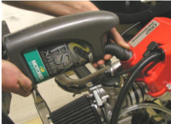
Füllen Sie nun 0.4l 0W30 Öl von Motorex in den Motor.
