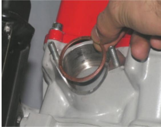
Legen Sie die Auspuffdichtung in den Auslasskanal. Montieren Sie den Auspuffkrümmer lose mit 2 Flanschmuttern M6.
