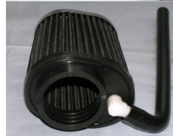
Stülpen Sie den Entlüftungsschlauch über den Schlauchverbinder und stecken diesen in das Loch am Luftfilter.
