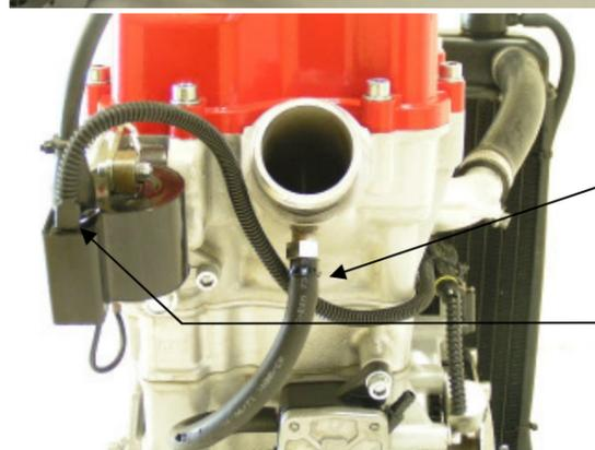
Verlegen Sie das Primärkabel hinter dem Unterdruckschlauch durch.
