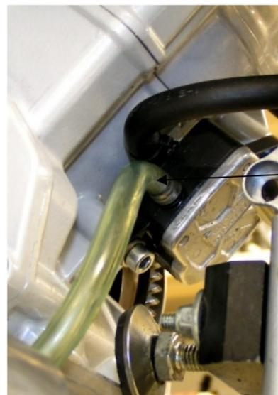
Verlegen Sie die Benzinleitung und schliessen Sie sie an der freien Stelle der Benzinpumpe an.
