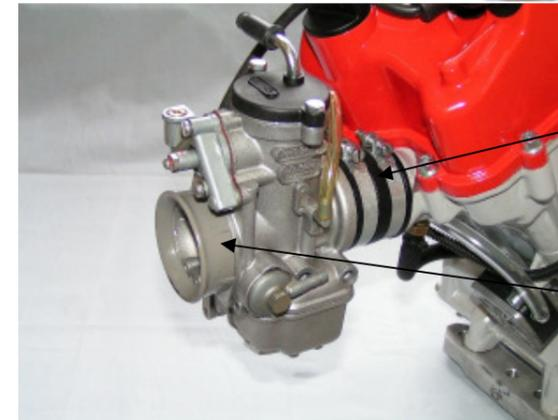
Stecken Sie den Vergaser in den Vergasergummi und ziehen die beiden Schlauchklemmen fest. Achten Sie darauf, dass der Vergaser waagrecht montiert ist.
