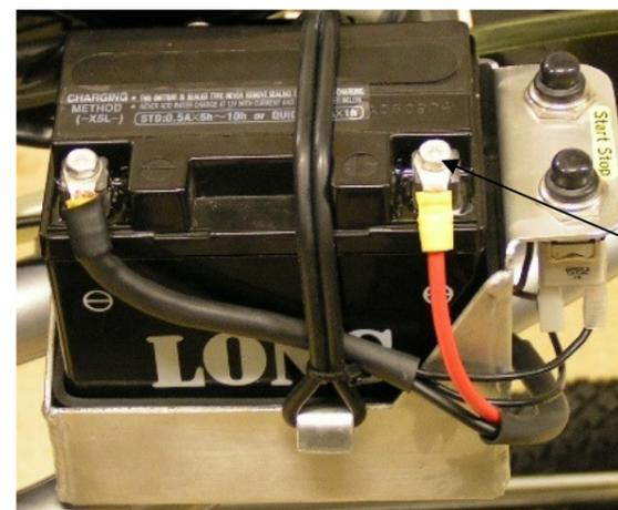
Befestigen Sie das Plus- und Minuskabel mit den mitgelieferten Nutensteinen und Schrauben.
